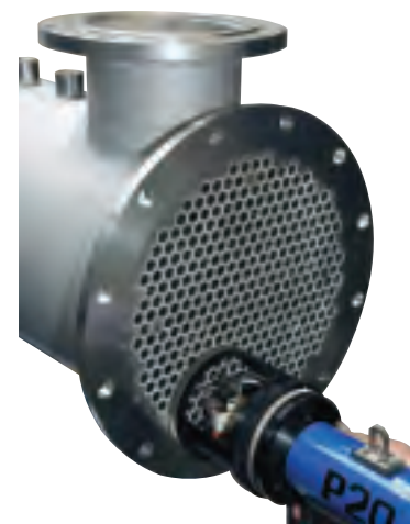
Automatyczne łączenie końcówki rury i całkowita kontrola
